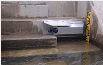
El OTT SLD sirve para medir continuamente la velocidad de flujo y el nivel de agua (opcional). Para medir la velocidad de flujo utiliza el principio acústico Doppler.
